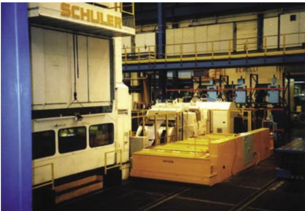
Chariot motorisé à conducteur accompagnant construit sur châssis mécanosoudé acceptant une charge de deux fois 36,5 tonnes (Doc Serapid)
