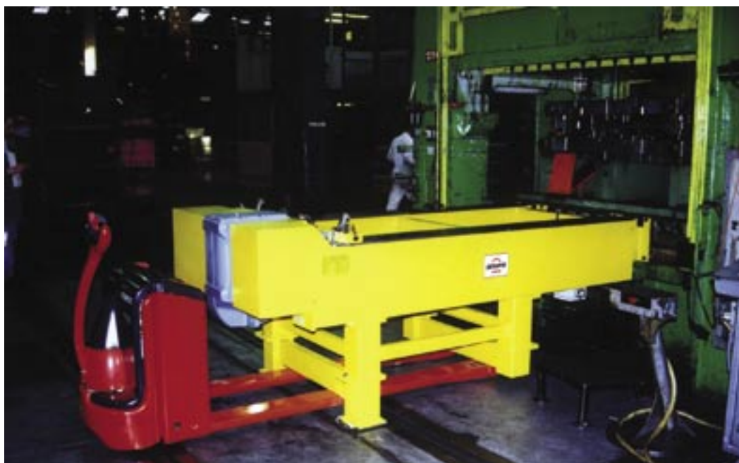
Gerbeur fixé sous la table capable de desservir deux presses. Effort de poussée 4120 N à la vitesse de 50 mm/s sur une course de 2500 mm (Doc Serapid)
