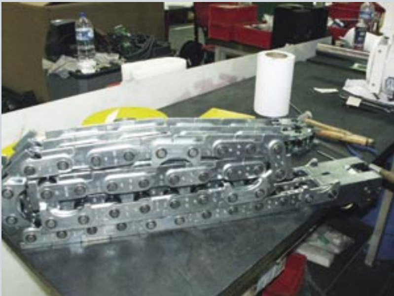
Photo ci-dessus : pour qu'une chaîne puisse être utilisée comme un vérin double effet, la géométrie de ses maillons doit comporter un talon spécial (Doc J.G)
