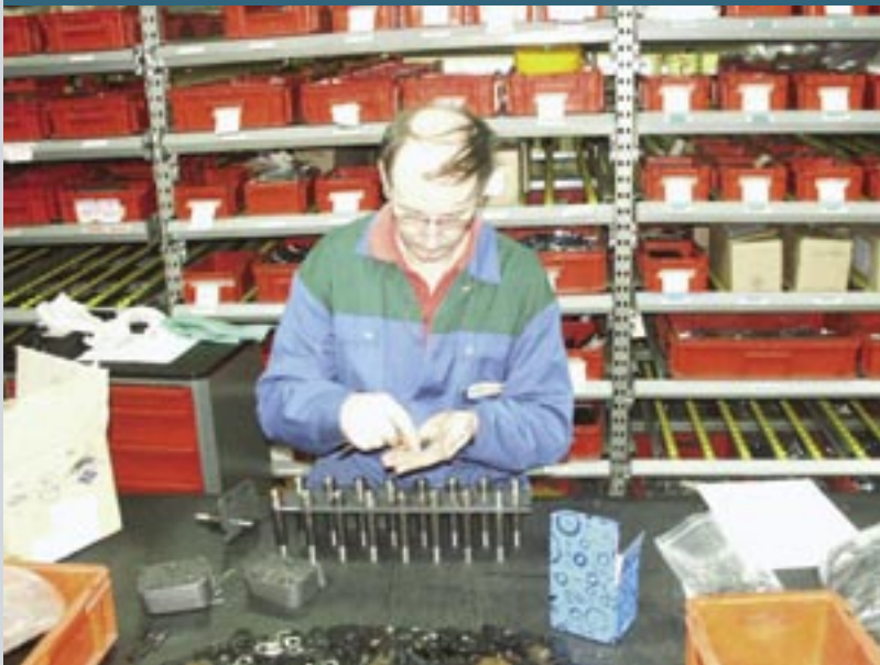
Photo ci-dessous : chaîne rigide de poussée en cours de montage (Doc J.G)
