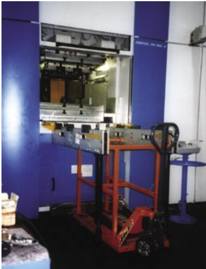
Paire de console fixée sur un transpalette manuel avec accrochage avant des consoles sur la presse (Doc Serapid)
