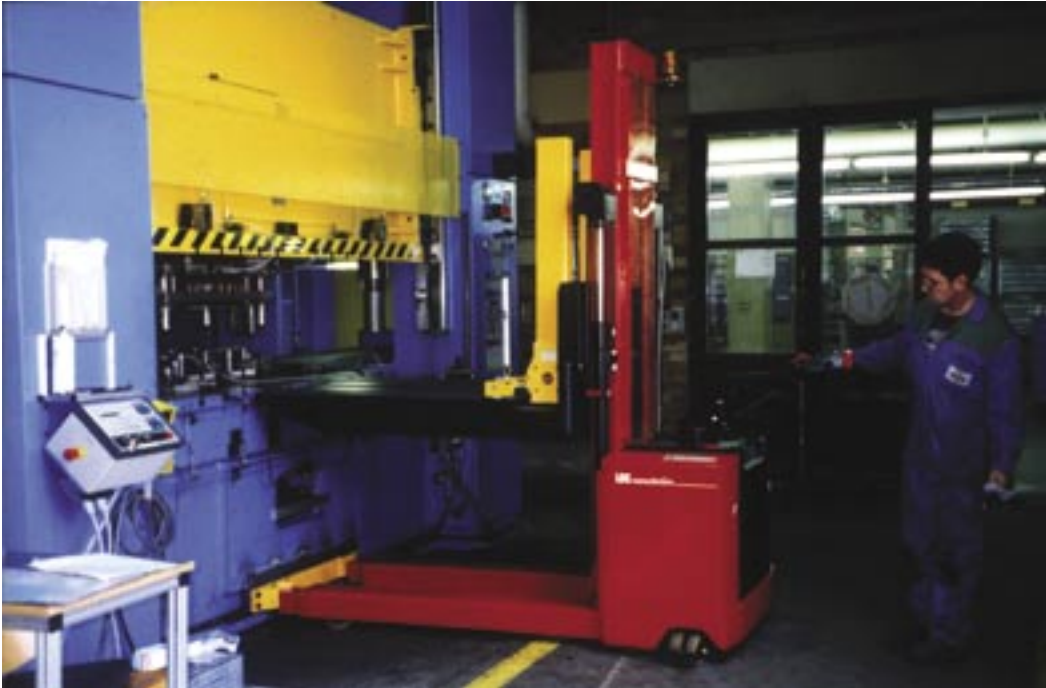
Chariot gerbeur et table porte outil ayant une course verticale de 1780 mm. L'ensemble autonome est alimenté par batterie et dessert deux racks de stockage de 15 outils sur trois niveaux (Doc Serapid)
