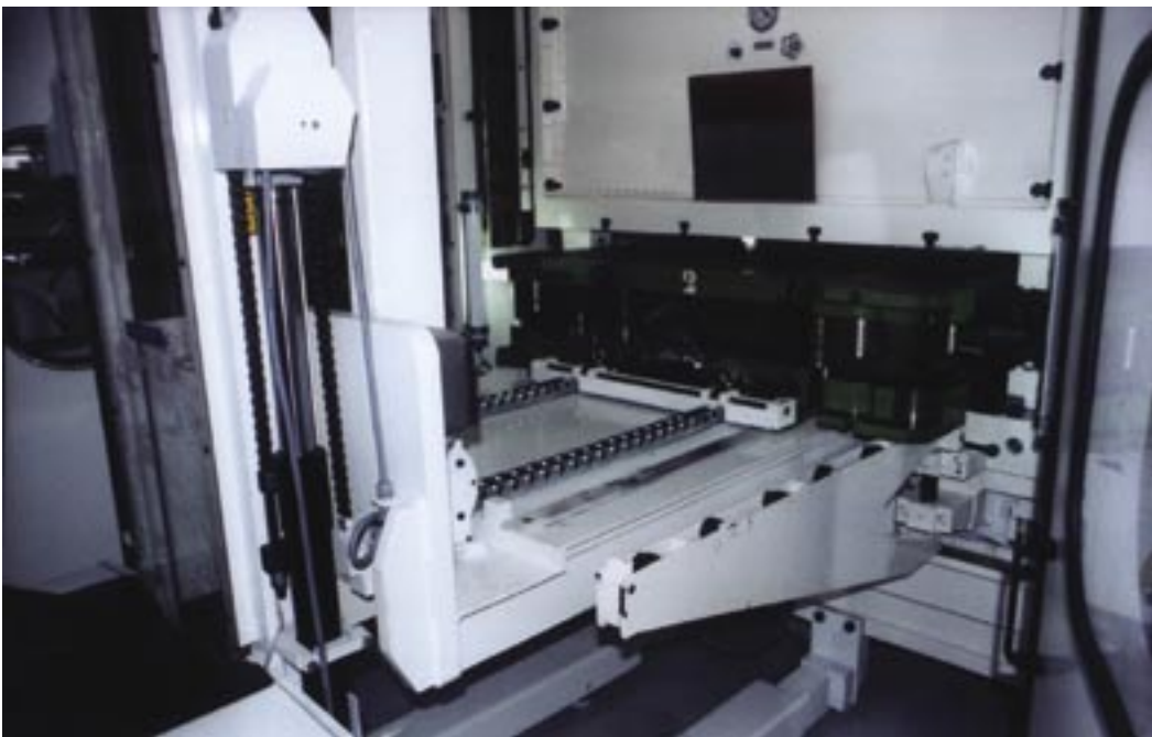
Chariot gerbeur et table porte outil ayant une course verticale de 1780 mm. L'ensemble autonome est alimenté par batterie et dessert deux racks de stockage de 15 outils sur trois niveaux (Doc Serapid)
