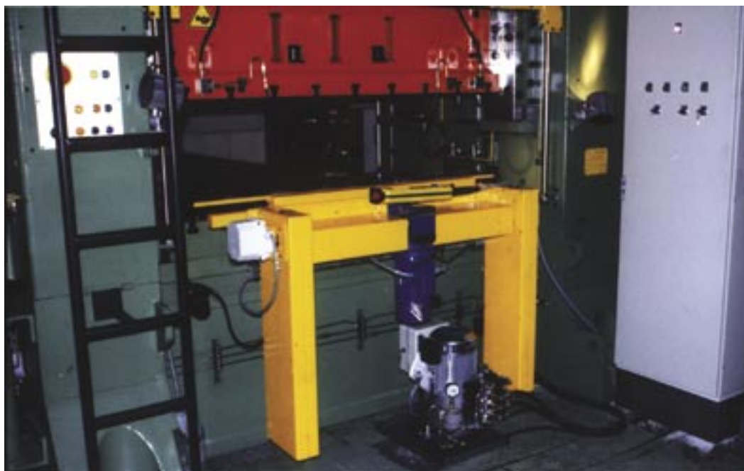
Système intégré de pousseur arrière avec bridage hydraulique sous presse et console de dépose outil. L'ensemble est alimenté avec un groupe hydraulique (Doc Serapid)
